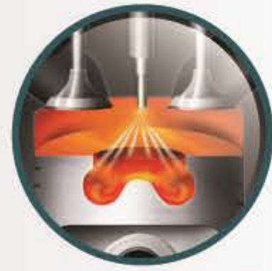
หัวฉีดเชื้อเพลิงแนวตั้ง กลางลูกสูบพร้อมลูกสูบ รูปทรงแบบมีโคตรงกลาง
